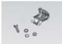
Universal-Leuchten-Abhänger für Spanndraht ( \phi \leq 4,5\text{mm} ) oder Kette ( \phi_{\text{Innen}} \geq 7\text{mm} ) Tragkraft: 25kg
