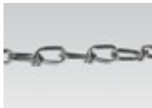
Knotenkette, verzinkt Gliedmaß Innen 7 x 40mm Tragkraft: 56kg
