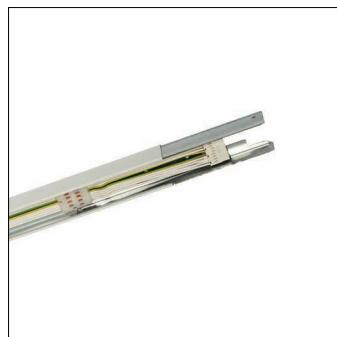
Modario, Tragschiene, aus Stahlblech, lackiert, leuchtenweiß, 2längig, Länge: 2.392 mm, Breite: 58 mm, Höhe: 43mm, Durchverdrahtung: 10x 2,5mm<sup>2</sup>, mit Klemme, 10polig, max. 2,5mm<sup>2</sup>, Schutzart (gesamt): für Schutzart IP20/IP40, Schutzklasse (gesamt): SK I (Schutzerdung), Prüfzeichen: CE, ENEC, VDE, Norm: EN 60598, Verpackungseinheit: 1 Stück
