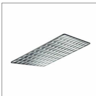
Spiegel-Werfer-Reflektor, für SITECO Mirrortec Indoor, Kugelgelenk-Pendelabhängung, Gehäuse, quadratisch, aus Aluminium, lackiert, weißaluminium (RAL 9006), Fresnel Reflektor 100, aus PMMA, Alu bedampft, hochglänzend, Lichtpunkt-Zerlegung, Fresnelstruktur, Länge: 900 mm, Breite: 900 mm
