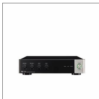
SITECO Connect Audio, Verstärker, Montageart: als Tischaufbau, Desktop-Mixer-Leistungsverstärker, Netzanschluss: 100..240V, AC, 50/60Hz, Bemessungsleistung: 120W, Gehäuse, aus Metall/Kunststoff, lackiert, schwarz, Länge: 375mm, Breite: 210mm, Höhe: 53mm, Prüfzeichen: CE, Verpackungseinheit: 1 Stück
