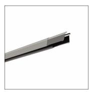
Licross®, Tragschiene, aus Stahlblech, verzinkt, bandlackiert, weißaluminium (RAL 9006), Länge: 3.000 mm, Breite: 64 mm, Höhe: 67mm, Durchverdrahtung: 11x 2,5mm², Schutzart (gesamt): maximal IP64, abhängig von den verwendeten Einsätzen und Zubehören, Schutzklasse (gesamt): SK I (Schutzerdung), Prüfzeichen: CE, UKCA, LABS-Konformität geprüft gemäß VDMA 24364:2018-05, Verpackungseinheit: 1 Stück
