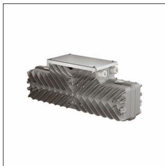
Sirius, EVG-Einheit, 3/4polig (3/4G) + 1polig (LST) / 2polig (DALI), max. 2,5mm<sup>2</sup>, Vorschaltgerät: DALI, Leistungsreduzierung, mit Klemme, Netzanschluss: 220..240V/380..415V, AC, 50/60Hz, mit Systemverbinder oder Klemme, EVG-Einheit, aus Aluminium-Druckguss, pulverbeschichtet, SITECO eisenglimmer (DB 702S), Länge: 635mm, Breite: 181mm, Höhe: 247mm, Schutzart (gesamt): IP66, Schutzklasse (gesamt): SK I (Schutzerdung), Prüfzeichen: CE, ENEC, Verpackungseinheit: 1 Stück
