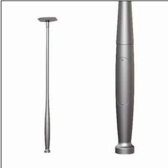
Mast, Mast, konisch rund, aus Aluminium, lackiert, Siteco® eisenglimmer (DB 702S), Höhe: 6,0m, Zopfmaß: 76mm (Aufsatz), Erdstück: h= 1000mm / Ø= 140mm, Norm: DIN EN 40, Verpackungseinheit: 1 Stück
