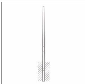
Mast, Mast, konisch rund, aus Stahl, pulverbeschichtet, SITECO eisenglimmer (DB 702S), Höhe: 8,0m, Zopfmaß: 76mm (Aufsatz), Erdstück: h= 1200mm / Ø= 168mm, Norm: DIN EN 40, Verpackungseinheit: 1 Stück
