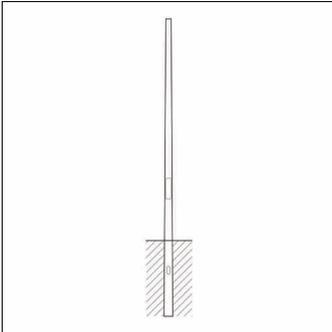
Mast, Mast, konisch rund, aus Stahl, verzinkt, Höhe: 8,0m, Zopfmaß: 76mm (Aufsatz), Erdstück: h= 1200mm / Ø= 168mm, Norm: DIN EN 40, Verpackungseinheit: 1 Stück
