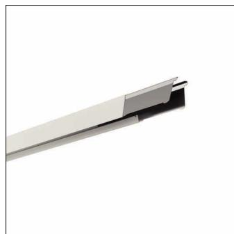
Licross, Tragschiene, aus Stahlblech, verzinkt, bandlackiert, weiß, Länge: 1.500 mm, Breite: 64 mm, Höhe: 67mm, Schutzart (gesamt): maximal IP64, abhängig von den verwendeten Einsätzen und Zubehören, Schutzklasse (gesamt): SK I (Schutzerdung), Prüfzeichen: CE, UKCA, LABS-Konformität geprüft gemäß VDMA 24364:2018-05, Verpackungseinheit: 1 Stück
