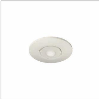
SITECO ConnectSensor PC4, Slave, lokale Steuerung - autarke standalone Sensorik, zentrale Steuerung - Anbindung an Licht- oder Gebäudemanagement, dimmbar, Montageart: Einbau, Montageort: in der Decke, aus Kunststoff, Schutzart (gesamt): IP20, Schutzklasse (gesamt): SK II (Schutzisoliert), Prüfzeichen: CE, 1 x PIR-Bewegungssensor, 1 x Lichtsensor, 1 x LED rot/grün, Verpackungseinheit: 1 Stück
