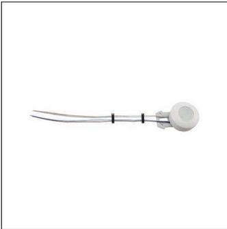
Highbay 11Sensor PC8, Master, lokale Steuerung - autarke standalone Sensorik, zentrale Steuerung - Anbindung an Licht- oder Gebäudemanagement, dimmbar, Montageart: Anbau, Montageort: an der Leuchte, aus Kunststoff, Schutzart (gesamt): IP54, Prüfzeichen: CE, Spannung: 230V, 1 x PIR-Bewegungssensor, 1 x Lichtsensor, 1 x DALI, 1 x Bluetooth®-Schnittstelle, Verpackungseinheit: 1 Stück
