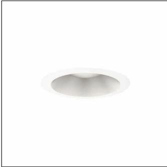
Lunis 31, -XL, Downlight, Lichtlenkung mit Linse, Lichtaustritt: direkt strahlend, LED Bemessungslichtstrom: 2.380lm, Lichtfarbe: 830, Netzanschluss: 220..240V, AC/DC, 0/50..60Hz, Gehäuse, aus Aluminium, weiß, Schutzart (gesamt): IP20, Schutzart (raumseitig): IP54, Schutzklasse (gesamt): SK II (Schutzisoliert), Prüfzeichen: CE, ENEC, Verpackungseinheit: 1 Stück
