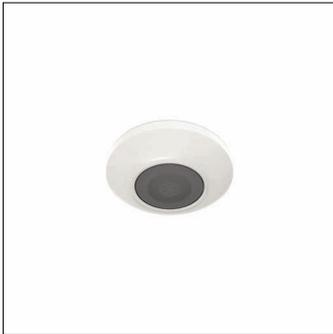
SITECO Connect 11H WirelessNode Multisensor PC8, Master, lokale Steuerung - autarke standalone Sensorik, dimmbar, Montageart: Anbau, Montageort: an der Decke, aus Kunststoff, Schutzart (gesamt): IP54, Schutzklasse (gesamt): SK II (Schutzisoliert), Prüfzeichen: CE, UKCA, Spannung: 220..240V, Spannungsart: AC, 1 x PIR-Bewegungssensor, 1 x Lichtsensor, 1 x DALI, 1 x Bluetooth®-Schnittstelle, Verpackungseinheit: 1 Stück
