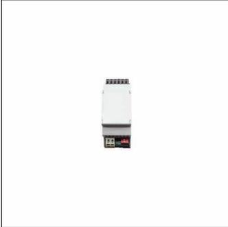
DALI2Repeater, Master, zentrale Steuerung - Anbindung an Licht- oder Gebäudemanagement, dimmbar, Montageart: Einbau, Montageort: in einer elektr. Verteilung, aus Kunststoff, Teileinheiten: 2 Teileinheiten, Schutzart (gesamt): IP20, Schutzklasse (gesamt): SK II (Schutzisoliert), Prüfzeichen: CE, UKCA, Spannung: 100..240V, Spannungsart: AC, 1 x DALI, 1 x TouchDim-Eingang, 1 x DALI broadcast, Verpackungseinheit: 1 Stück
