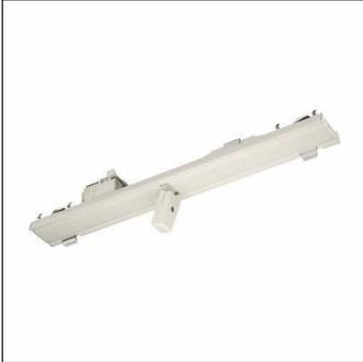
Licross® Sensor-Module HE1-M, Master, lokale Steuerung - autarke standalone Sensorik, dimmbar, Montageart: Einbau, Montageort: an der Licross® Tragschiene, aus Stahlblech, Schutzart (gesamt): IP20, Schutzklasse (gesamt): SK I (Schutzerdung), Prüfzeichen: CE, UKCA, Spannung: 230V, Spannungsart: AC, 1 x HF-Bewegungssensor, 1 x PIR-Bewegungssensor, 1 x DALI, 1 x Status-LED, Verpackungseinheit: 1 Stück
