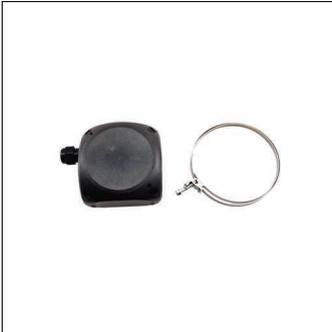
SITECO Connect SportLeuchtencontroller, lokale Steuerung - autarke standalone Sensorik, dimmbar, Konfiguration per Casambi-App, Montageart: Anbau, Montageort: am Mast, aus Kunststoff, Schutzart (gesamt): IP66, Schutzklasse (gesamt): SK II (Schutzisoliert), Prüfzeichen: CE, Spannung: 230V, Spannungsart: AC, EVG-DALI, Bluetooth®, Verpackungseinheit: 1 Stück
