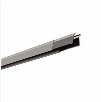
Licross®, Tragschiene, aus Stahlblech, verzinkt, bandlackiert, weißaluminium (RAL 9006), Länge: 3.000 mm, Breite: 64 mm, Höhe: 67mm, Durchverdrahtung: 14x 2,5mm<sup>2</sup>, mit Klemme, 14polig, max. 2,5mm<sup>2</sup>, Schutzart (gesamt): maximal IP64, abhängig von den verwendeten Einsätzen und Zubehör, Schutzklasse (gesamt): SK I (Schutzerdung), Prüfzeichen: CE, Verpackungseinheit: 1 Stück
