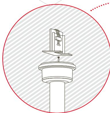
Geräteträger einsetzen und anschließen.
