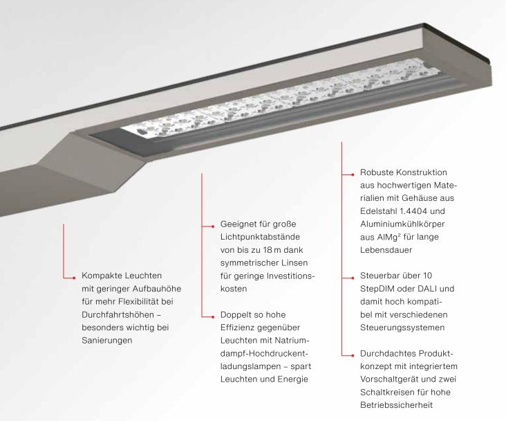
Mit spezieller, asymmetrischer Lichtverteilung nach dem Gegenstrahlprinzip für kontrastreichen Sehkomfort oder symmetrischer Lichtverteilung für eine besonders angenehme Adaptierung an das niedrigere Lichtniveau der Tunneldurchfahrtszone
